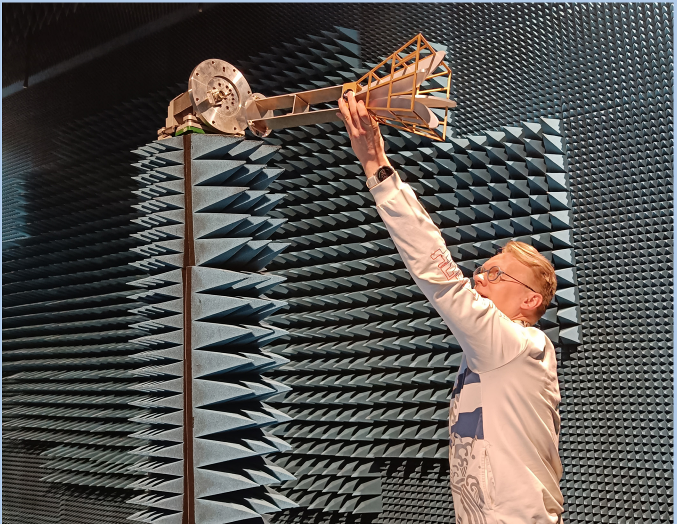
Radiokaiutonta huonetta käytetään muun muassa antennien mittaamiseen ja kalibroimiseen.
