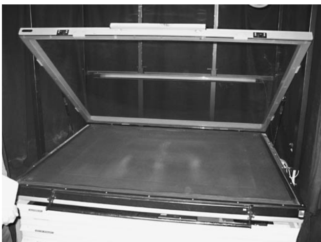
Tällä asemointipöydällä filmikasetista kehitetyt kalvot valotetaan levyille, jotka asetetaan painokoneeseen painon ajaksi.
