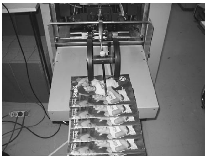
Painamisen ja arkkien järjestelemisen jälkeen keräilykone viimein kasaa lehden ja nitoo arkit toisiinsa kiinni.
